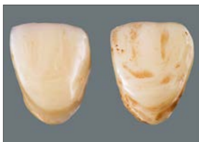
Obr. 1: vlevo: plně zpolymerováno, téměř žádné zbarvení vpravo: zpolymerováno příliš krátce, výrazné zbarvení
