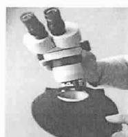
21. Vložte mikroskop do kroužku mikroskopického držáku...
