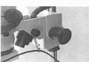
59. Otočením knoflíku na mikroskopickém držáku přivedeme obráběný kus k ohnisku. Pokud nelze dosáhnout bodového ohniska, nastavte výšku držáku.
