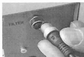
48. Zapojte elektronickou uzávěrku (clonu) do kontrolní jednotky zasunutím kabelu do zásuvky v zadním panelu jednotky s označením „Filter“.
