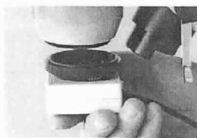
25. K instalování elektronické uzávěrky (clony) nejprve vyšroubujte ochranný kroužek k odkrytí závitu. Přiložte uzávěrku (clony) na místo...
