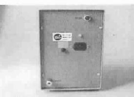
**6. Vzhled zadního panelu s elektrickou zásuvkou, držákem pojistky, připojení na argon a objímka uzávěrky.**
