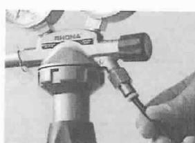
65. Vsuňte volný konec plynové hadice (již spojené s kontrolní jednotkou) do rychloupínacího ventilu tlakového regulátoru.
