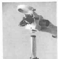
17. Instalujte mikroskopický držák se světelnou jednotkou připojenou k mikroskopickému stojanu a zajistěte držák pomocí...
